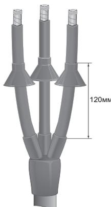
Данная операция добавляется только для монтажа муфт наружной установки типа ЗКНТп-10
